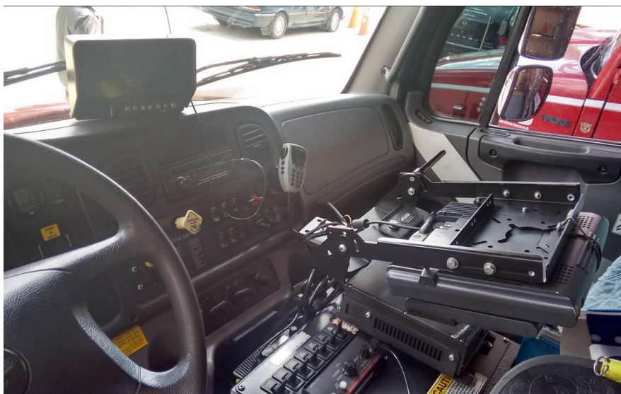
Imagen GPS y sistema de información instalado en maquina de atención de emergencias
